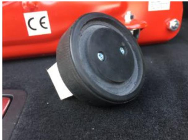
Anschließend haben wir in unseren bereits auf Maß gesägten Kunststoffklotz zwei Gewinde geschnitten. In den Puck bohrten wir dann dazu passende Durchgangslöcher und brachten Flachsenkungen für die Zylinderkopfschrauben ein. Nun mussten wir den Klotz nur noch mit dem Puck verschrauben.
