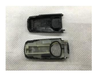
Nun kann man die Batterie einfach heraushebeln und ersetzen. Bei der Gelegenheit kann man den Schlüssel auch gleich vorsichtig entstauben und reinigen.
